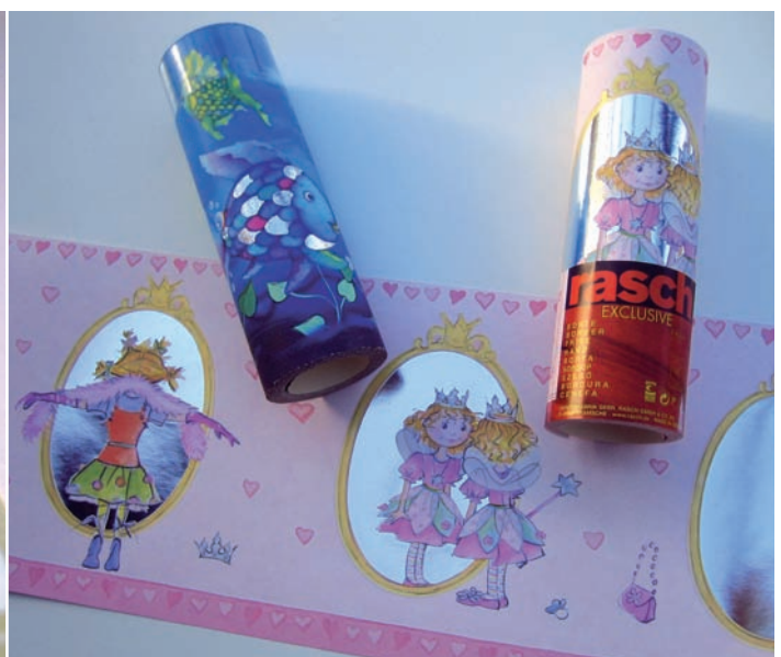
Mehrstufige Reliefprägung auf Faltschachteln (links). Tapetenbordüre mit Planprägung silber (rechts).
